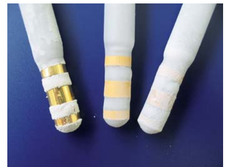
AUTOMATISCHE SONDENREINIGUNG (ASR): mit ASR nach zwölf Wochen (links), ohne ASR nach vier Wochen (Mitte) bzw. acht Wochen (rechts)
